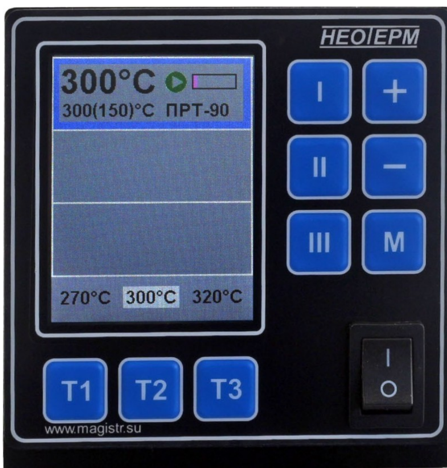
Фото 2. Передняя панель блока управления
